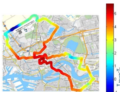
Figuur 6: Temperatuurverschillen tussen mobiele metingen en weerstation KNMI op Rotterdam Airport (22:00 – 24:00, 6 augustus 2009).
